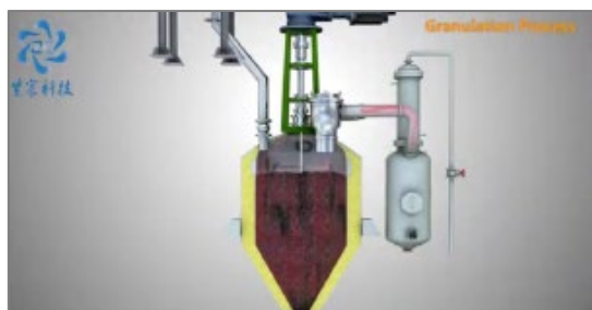
Figur 16. Vertikalugn för granulering. Reaktionskärlet värms enligt en viss uppvärmningskurva (200–900 °C).
