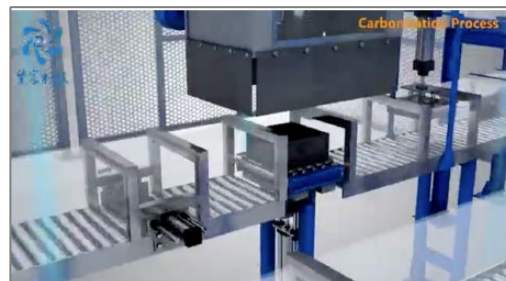
Figur 30. Materialet fylls i grafitlådor och transporteras vidare för värmebehandling.
