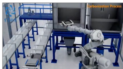
Figur 32. Efter värmebehandlingen flyttas grafitlådorna av en robotarm för att samlas upp i en vakuumuppsamlare.
