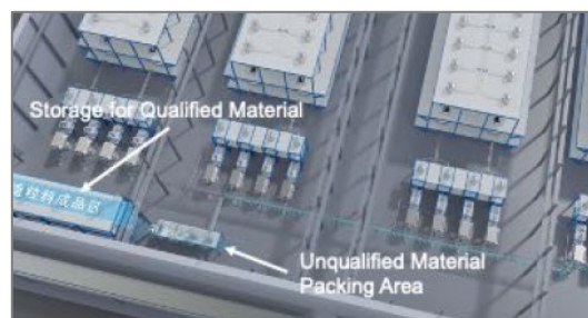
Figur 22. Materialet som uppfyller kraven lastas i säckar i väntan på nästa processsteg. Okvalificerat material packas och återanvänds innan det säljs vidare.
