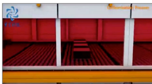
Figur 31. I värmebehandlingen upphettas grafitlådorna (500–1 300 °C).
