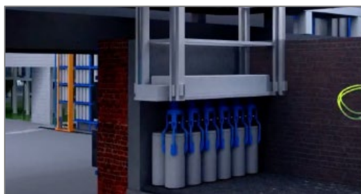
Figur 25. Kittlar med material/produkt placeras i ugnen med hjälp av robotarm.
