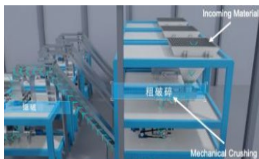
Figur 10. Inkommande råmaterial levereras till matningssilos för att i ett första steg krossas grovt.
