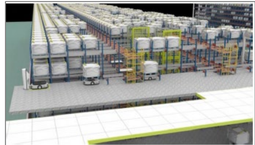
Figur 8. Omlastning av säckarna (big bags) till lagringsplats sker med hjälp av elektriska robotar.
