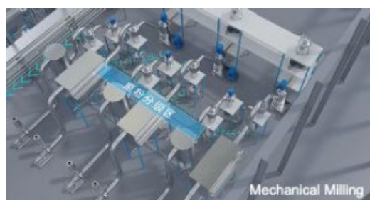
Figur 13. Vid den mekaniska finmalningen framställs rätt partikelstorlek inför vidare processer.
