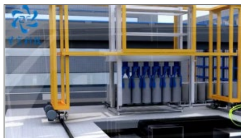
Figur 24. Fyllda kittlar förflyttas från fyllningsstationen med hjälp av en robotarm.
