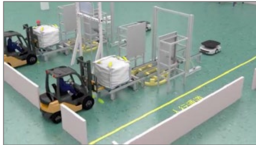
Figur 7. Råvarorna levereras till anläggningen i stora säckar (big bags). Lastning från container till dockningsstation sker med elektrisk gaffeltruck.
